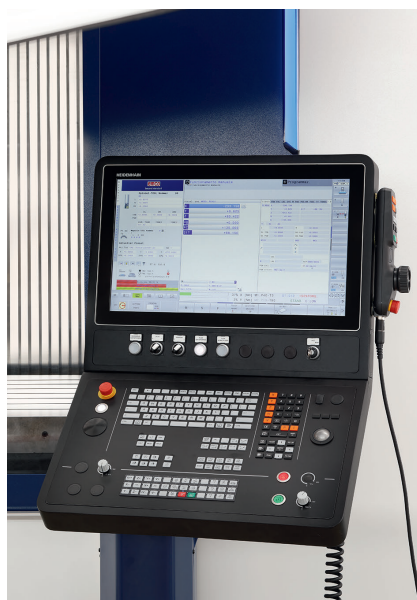
2 Unterschiedliche Steuerungsoptionen von Siemens oder Heidenhain erlauben eine Bedienung ohne Umstellung © Emco
