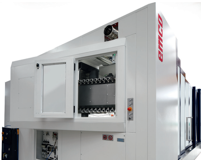
3 Bei der Variante MMV 5200 ist ein 60-fach-Werkzeugmagazin integriert © Emco
